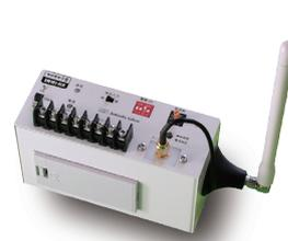
警報信号の送信のみを行う専用子機です。各種センサーや測定器からの接点出力を接続します。送信機能のみのため、単 3 乾電池 2 本で約半年間稼働することができます。
