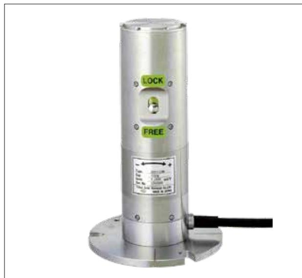
低容量型の傾斜計です。都市土木などにおける近接構造物の変状管理計器として使用されます。KB-AB型は1軸用で、KB-AC型はX方向とY方向の測定が1台でできる2軸型です。アレスタ内蔵も製作可能です。熱電対を内蔵した測温機能付もあります。
